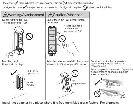
Install the detector in a place where it is free from false alarm factors. For example: Installer le détecteur dans un emplacement ne présentant pas de cause de fausses alarmes. Par exemple :
